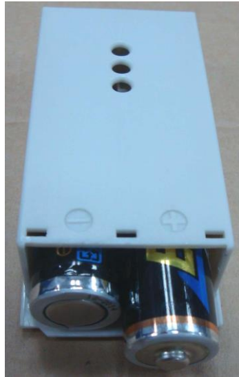
3-2. ábra Az elemek behelyezése a rekesz fedelébe
